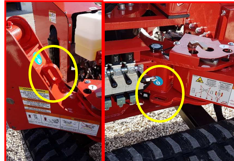
Afbeelding 16: bevestigingspunten op het onderstel voor het ophangen van de hoogwerker.
